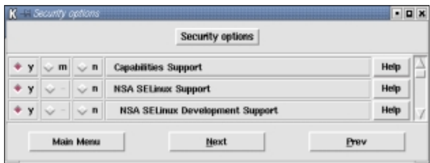
Abbildung 3: Beim Konfigurieren mit »make xconfig« müssen innerhalb der Security-Optionen einige Module noch in den Kernel eingebunden werden: »Capabilities Support« und »NSA SELinux Support« sind Pflicht, der Development-Support ist praktisch.
